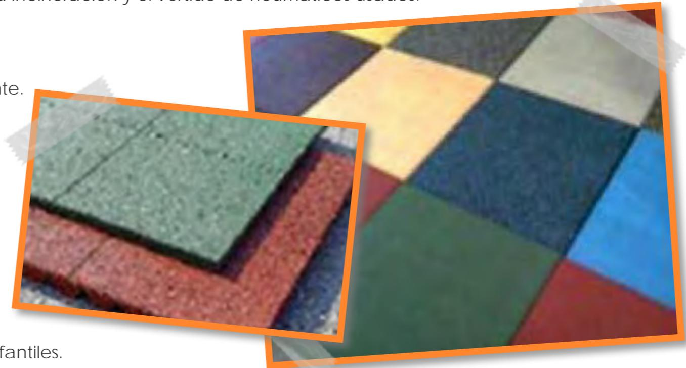
Dada la naturaleza de la superficie sintética, caucho, es normal que las placas sufran contracción con temperaturas bajas y expansión con temperaturas altas. Estos valores hacen oscilar el tamaño de la placa entre + / - 3% . Este fenómeno se acentúa con la edad de la placa.
